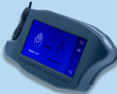
Abbildung 2: Bedieneinheit mit Möglichkeit zur Griffmusterwahl
